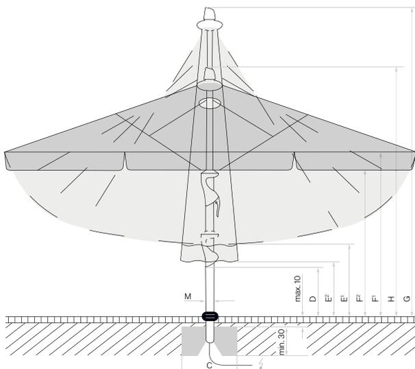
Revêtement de chaussée non fixé max. 10 cm, épaisseur du béton min. 30 cm (tenir compte de la profondeur hors gel),Garantir l'écoulement de l'eau, Ligne d'alimentation électrique.
